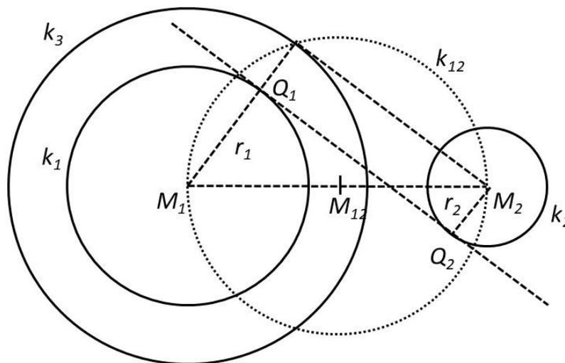
1. Dazu konstruieren wir zunächst einen weiteren Kreis  $k_3$  mit Mittelpunkt  $M_1$  und Radius  $r_1 + r_2$ .
