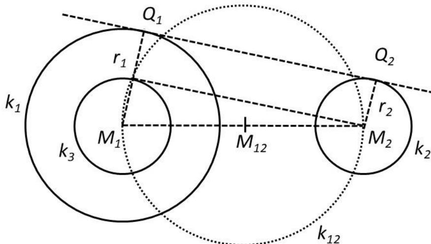
1. Dazu konstruieren wir zunächst einen weiteren Kreis  $k_3$  mit Mittelpunkt  $M_1$  und Radius  $r_1 - r_2$ .
